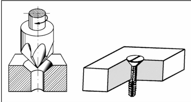
3. **Rebaixar furos** – consiste em aumentar o diâmetro de um furo até uma profundidade determinada. O rebaixo destina-se a alojar cabeças de parafusos, rebites, porcas, buchas. Com esse rebaixo, elas ficam embutidas, apresentando melhor aspecto e evitando o perigo de acidentes com as partes salientes. Como a guia do rebaixador é responsável pela centralização do rebaixo, é importante verificar seu diâmetro de modo que o diâmetro da broca que faz o furo inicial seja igual ao da guia.
