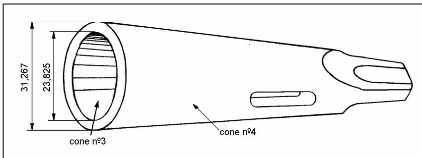
**Cone Morse:** na máquina-ferramenta, é a medida padronizada da conicidade do alojamento de brocas, dos alargadores em furadeiras fresadoras, e em pontas de torno.
