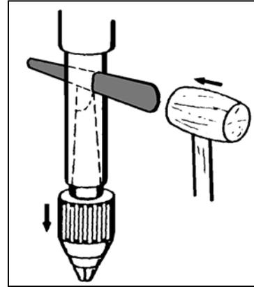
Para um ajuste correto da ferramenta, antes de efetuar a montagem das brocas, mandris, buchas, rebaixadores, escareadores deve-se fazer a limpeza dos cones, retirando qualquer traço de sujeira.
